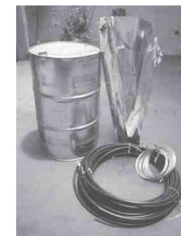
Tambor galvanizado, malha de alumínio e mangueira de polietileno
