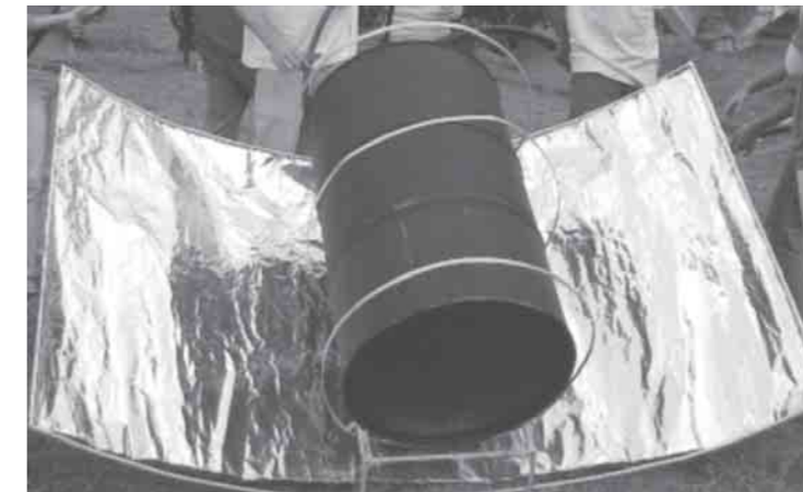
Manta de alumínio sob o aquecedor
