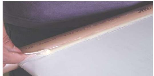
8. Após 24 horas, e **após o teste de vazamento descrito abaixo**, lixar levemente uma das faces do coletor e limpar com pano e álcool. Pintar a face com esmalte sintético preto fosco usando pincel ou rolinho, inclusive sobre a área da colagem e parte superior dos tubos. Use a fita crepe nos tubos, para um acabamento limpo na transição com e sem pintura. Deixar sem tinta apenas 3 cm das extremidades dos tubos para futuro encaixe dos componentes de PVC.
