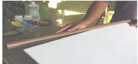
6. Deitar a placa sobre uma camada de 7 mm de jornal apoiada numa superfície horizontal. (Assim se mantém a posição correta dos tubos relativo à placa) Preparar sobre uma chapa limpa uma quantidade adequada do adesivo bi-componente misturado com talco mineral, permitindo que o adesivo fique pastoso.
